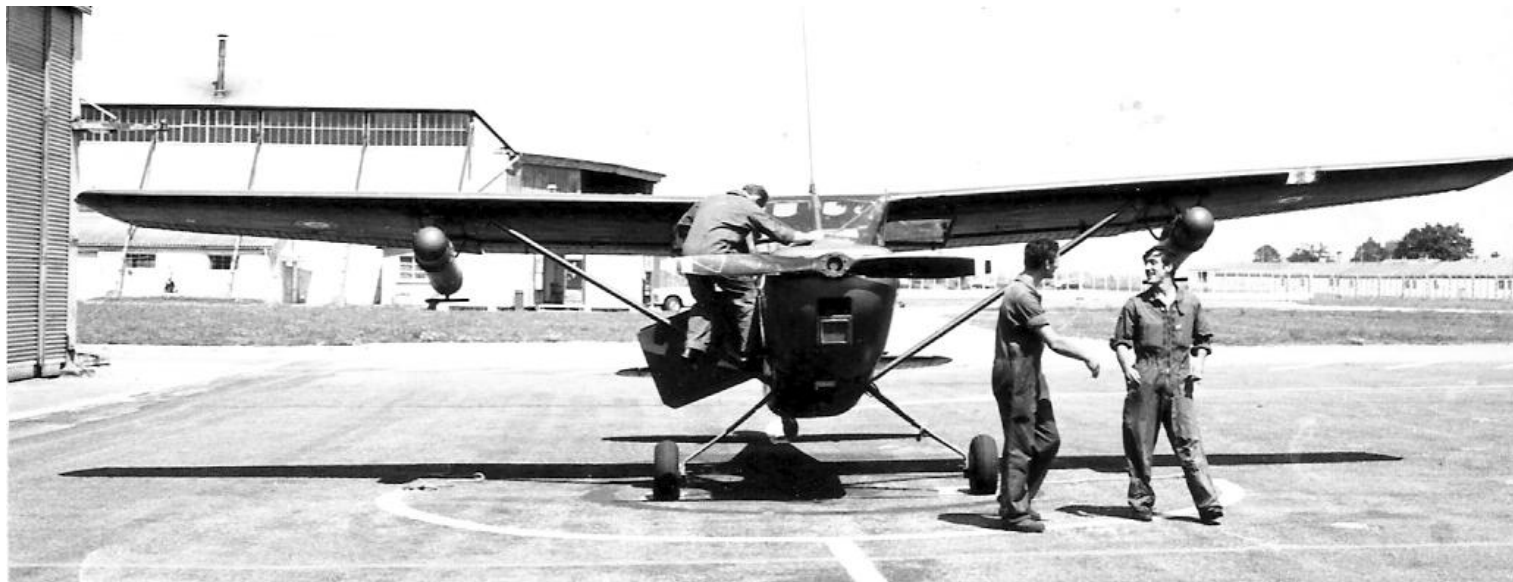
Bidons d'épandage fixés sur les supports Matra prévus initialement pour les lance-roquettes. (photo Sébastien Bonhomme et, ci-dessous, Fred Descamps).
